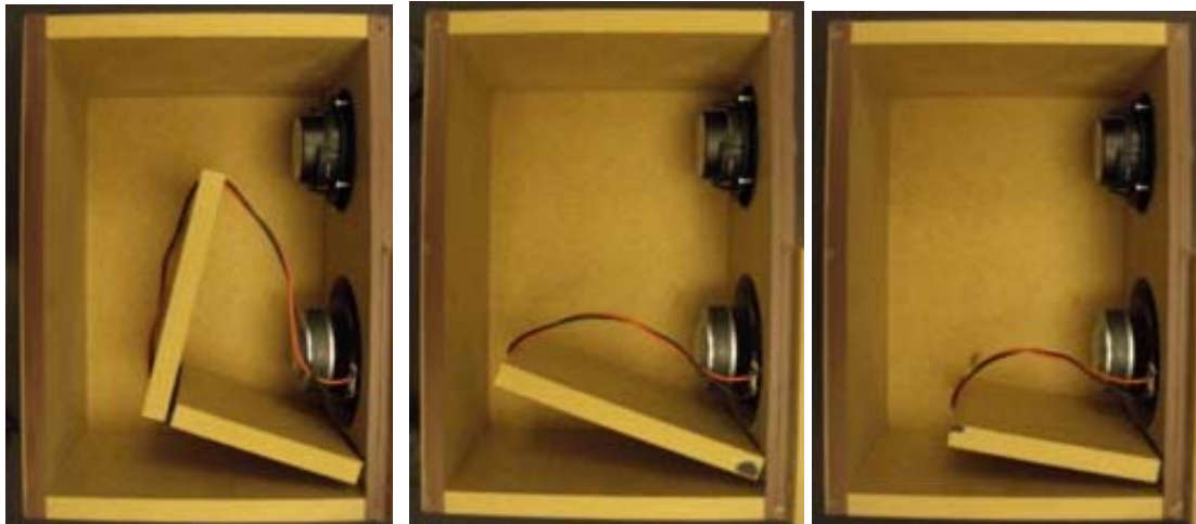
Bild 2.10 Ausführungen des Bassreflexkanals.
